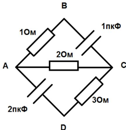
**Задача 5/2.** К точкам  $A$  и  $C$  схемы на рисунке подключено напряжение 10 В. Как изменится абсолютное значение заряда, запасенного в конденсаторах, если переключить это к напряжение к точкам  $B$  и  $D$ ? Ответ выразите в пкКл и округлите до сотых.
