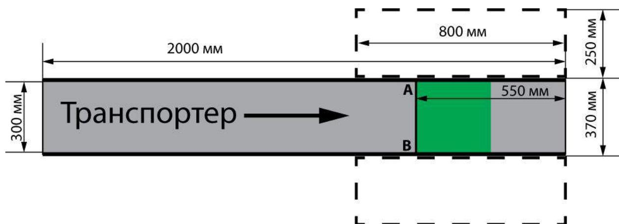
Робот и ящики для сбора деталей (изделий) должны располагаться рядом с транспортером в одной или одновременно двух зонах, обозначенных пунктирной линией. Длина каждой зоны равна 800 мм, а ширина – 250 мм. Ящики для деталей (изделий) имеют основание 200x200 мм, верхний край ящиков находится на одном уровне с лентой транспортера.
