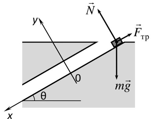
Запишем второй закон Ньютона для бруска в проекциях на оси координат и выражение для модуля силы трения скольжения:
