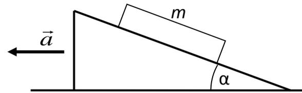
Максимальное значение модуля ускорения  $\vec{a}$ , при котором брусок сохраняет свое состояние покоя относительно основания при движении последнего, равно  $a = 0,8 \text{ м/с}^2$ . Найдите  $\alpha$  (в ответе достаточно указать численное значение  $\sin \alpha$ ,  $\cos \alpha$  или  $\text{tg } \alpha$ ). Ускорение свободного падения  $g = 10 \text{ м/с}^2$ .
