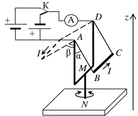
Если тот же ток протекает в направлении от  $C$  к  $B$ , то плоскость рамки отклоняется от плоскости  $AMD$  на угол  $\beta = 45^\circ$  в противоположном направлении.
