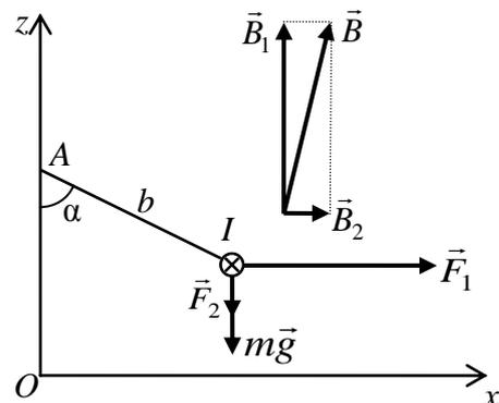
$$\begin{cases} I_1 B_z b \cdot b \cos \alpha_1 - (I_1 B_{\text{гор}} b + mg) \cdot b \sin \alpha_1 = 0, \\ I_2 B_z b \cdot b \cos \alpha_2 - (I_2 B_{\text{гор}} b + mg) \cdot b \sin \alpha_2 = 0. \end{cases}$$
