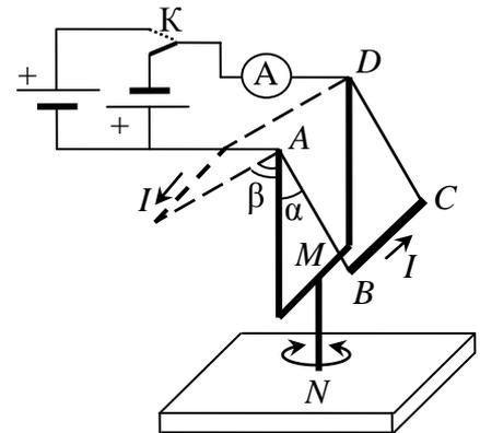
$I = 4 \text{ А}$  в направлении от  $B$  к  $C$ , то вилка поворачивается так, что отрезок  $BC$  устанавливается перпендикулярно вертикальной плоскости, в которой лежит вектор  $\vec{B}$ . Плоскость рамки при этом отклоняется от вертикальной плоскости  $AMD$  на угол  $\alpha = 30^\circ$  (см. рисунок). Если тот же ток протекает в направлении от  $C$  к  $B$ , то плоскость рамки отклоняется от плоскости  $AMD$  на угол  $\beta = 45^\circ$  в противоположном направлении.
