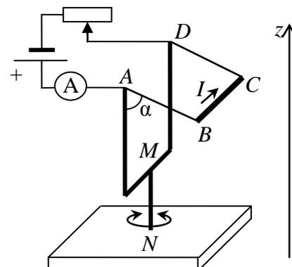
При  $I = I_1 = 4$  А угол  $\alpha = \alpha_1 = 30^\circ$ , при  $I = I_2 = 10$  А угол  $\alpha = \alpha_2 = 45^\circ$ . Найти проекцию  $B_z$  вектора  $\vec{B}$  на вертикальную ось  $z$ . Трением в шарнирных соединениях пренебречь.
