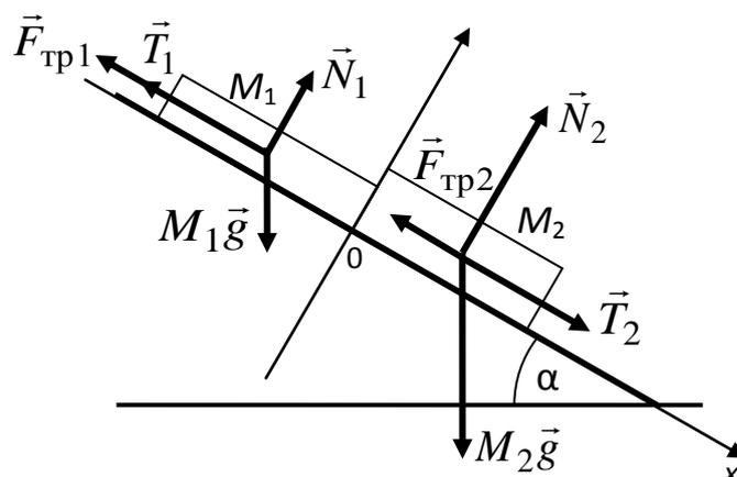
Здесь  $\vec{a}$  – ускорение плит,  $\vec{N}_1$  и  $\vec{N}_2$  – нормальные составляющие сил реакции, действующих на плиты со стороны наклонной плоскости,  $\vec{F}_{\text{тр}1}$  и  $\vec{F}_{\text{тр}2}$  – силы трения, действующие на плиты,  $\vec{T}_1$  и  $\vec{T}_2$  – силы взаимодействия между плитами. По 3-му закону Ньютона силы  $\vec{T}_1$  и  $\vec{T}_2$  по величине равны одному и тому же значению  $T$  и направлены во взаимно противоположные стороны.
