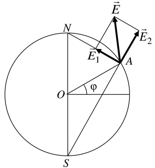
В нашем случае  $\angle NSA = \frac{1}{2} \angle NOA = \frac{1}{2} (90^\circ - \varphi) = 30^\circ$ , поэтому  $r_1 = AN = R$ ,  $r_2 = AS = R\sqrt{3}$ .
