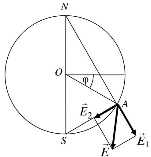
В нашем случае  $\angle SNA = \frac{1}{2}\angle SOA = \frac{1}{2}(90^\circ - \varphi) = 30^\circ$ , поэтому  $r_1 = AN = R\sqrt{3}$ ,  $r_2 = AS = R$ .
