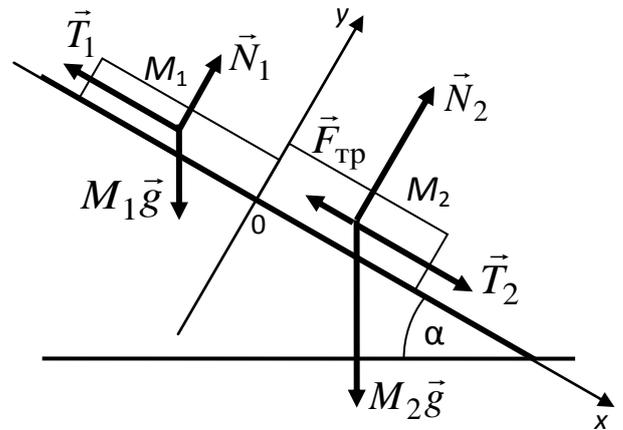
Выбирая направление оси  $Ox$  системы отсчета вниз вдоль наклонной плоскости, а оси  $Oy$  – вверх перпендикулярно к ней, запишем 2-й закон Ньютона в проекциях на оси координат:
