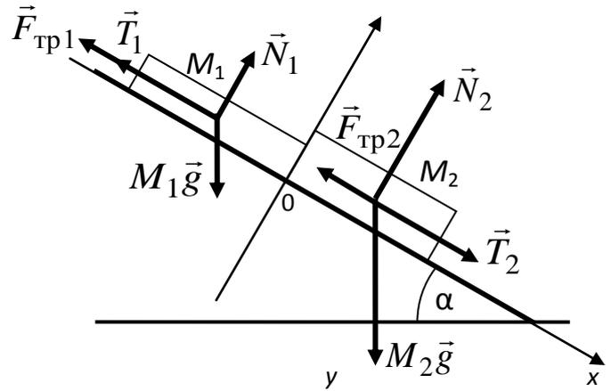
Выбирая направление оси  $Ox$  системы отсчета вниз вдоль наклонной плоскости, а оси  $Oy$  – вверх перпендикулярно к ней, запишем 2-й закон Ньютона в проекциях на оси координат:
