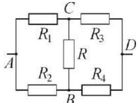
**3.** Электрическая цепь, схема которой изображена на рисунке, подключена к источнику постоянного напряжения в точках  $A$  и  $D$ . Известно, что сила тока через резистор  $R_2$  равна  $I_2 = 0,6$  А. Пренебрегая сопротивлением проводов, определите силу тока  $I_1$ , текущего через резистор  $R_1$ . Считайте, что  $R_1 = R_4 = 2R$ ,  $R_2 = R_3 = R$ , где  $R = 1$  Ом.
