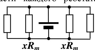
Суммарный ток через обе части одного реостата  $I_1 = \frac{U}{R} = \frac{L^2}{x(L-x)} \frac{U}{R_m} = 2,5$  А. Такой же ток
