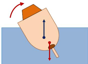
сила Архимеда равна по модулю и противоположна по направлению силе тяжести. Пусть корабль немного отклонился от вертикального положения. В первом случае, как видно из рисунка слева, момент этой пары сил возвращает корабль в вертикальное положение, а во
