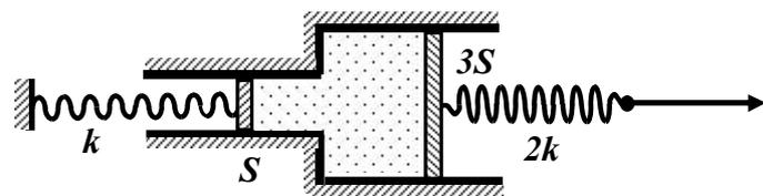
Между поршнями находится несжимаемая жидкость. Левый конец пружины с жесткостью  $k$  неподвижно закреплен. К правому, свободному концу пружины жесткости  $2k$  прикладывают внешнюю силу и медленно сдвигают этот конец пружины на расстояние  $L$ . Насколько при этом растянется другая пружина? Считать, что жидкость под поршни не подтекает, трения нет, а внешнее давление достаточно большое. Влиянием силы тяжести пренебречь.
