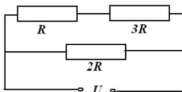
7. Найдите отношение максимальной мощности, выделяющейся на одном из резисторов, к минимальной. Сопротивления резисторов указаны на схеме.
