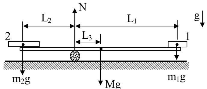
При вычислении моментов сил относительно точки опоры условие равновесия системы записывается следующим образом:
