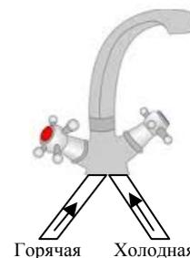
*Решение.* Если температура воды, вытекающей из крана, перестает меняться, то в обеих трубах значения температуры воды уже стали номинальными, т.е.  $T_x=20\text{ }^\circ\text{C}$  и  $T_r=70\text{ }^\circ\text{C}$  (+1 балл).
