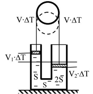
За некоторый промежуток времени  $\Delta T$  ось блока переместится на расстояние  $V \cdot \Delta T$ , а смещения поршней составят  $V_1 \cdot \Delta T$  и  $(-V_2 \cdot \Delta T)$ . Знак минус добавлен для того, чтобы учесть, что этот поршень двигается вниз, как и конец нити.
