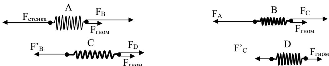
Например, обозначение  $F_D$  указывает, что имеется в виду сила, действующая со стороны пружины  $D$ . Пружины  $B$  и  $C$  взаимодействуют с двумя пружинами, поэтому соответствующих обозначений по два, но силы  $F'_B$  и  $F_B$  разные по величине!
