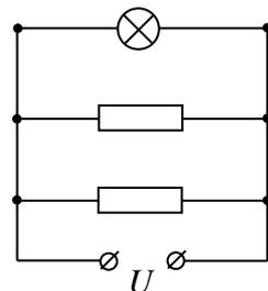
(3) **включен выключатель К<sub>2</sub>, выключен выключатель К<sub>1</sub>.** В этом случае наша электрическая цепь сводится к цепи, показанной справа на рисунке. При этом на нее приходится две трети напряжения источника  $2U/3$  (поскольку включенный с ней последовательно резистор имеет сопротивление  $R/2$ ). Следовательно, выделяемая на лампочке мощность в этом случае есть
