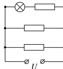
**(2) включен выключатель  $K_1$ , выключен выключатель  $K_2$ .** В этом случае цепь сводится к цепи, показанной справа на рисунке. И, следовательно, мощность выделяемая на лампочке совпадает с ее номинальной мощностью
