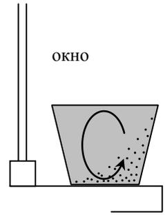
2. Пусть в единицу времени через батарею проходит масса воды  $\mu$ . Такое количество воды входит в батарею с температурой  $t_1$ , выходит с температурой  $t_2$ . Следовательно, в единицу времени батарея теряет  $c\mu(t_1 - t_2)$ , где  $c$  - удельная теплоемкость воды. Потеря батареей тепла в единицу времени и есть мощность батареи. Поэтому
