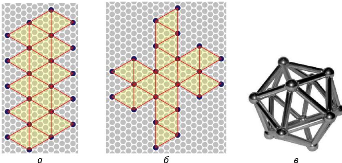
20 правильных треугольников, сходящихся по 5 в каждой из вершин, можно «собрать» единственно возможным образом (рис. 1а, б) – в форме икосаэдра (рис. 1в, каркасная модель) (он же – *скрученно удлиненная пятиугольная бипирамида*).
