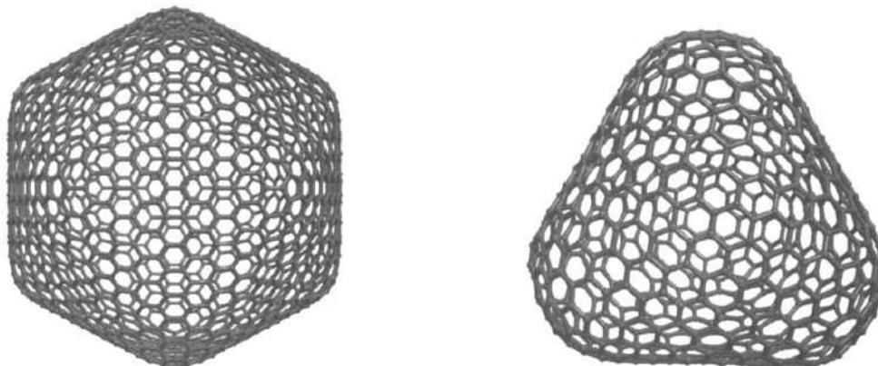
Рис. 1. Пример молекул гигантских икосаэдрического и тетраэдрического фуллеренов. Общее число атомов углерода в таких молекулах можно записать как  $N_I = 20(n^2 + nm + m^2)$  и  $N_T = 4(n^2 + nm + m^2) - 8$ , соответственно (где  $n$  и  $m$  – некоторые целые неотрицательные числа).
