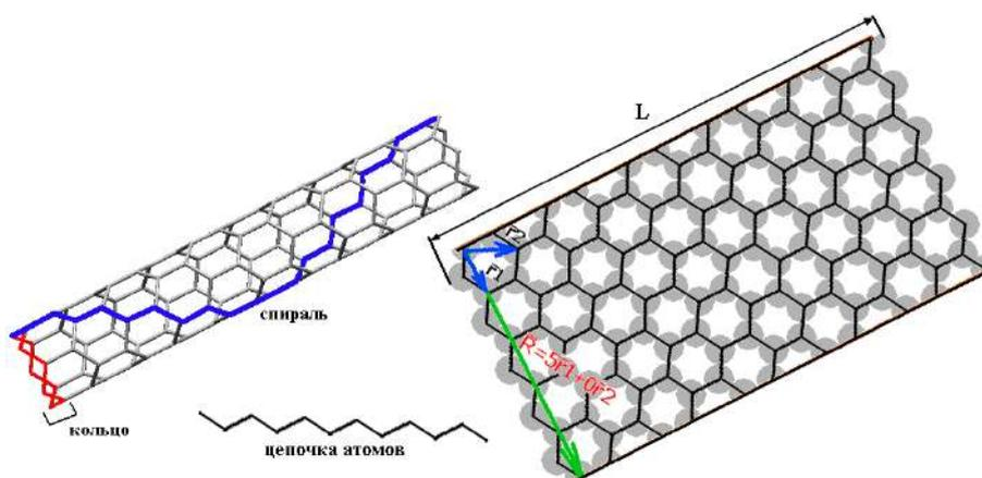
Рис. 1. УНТ с индексами хиральности  $(n, m)$  можно представить как фрагмент графенового листа, ограниченный параллельными линиями и свернутый вдоль направления радиус-вектора  $\vec{R} = n\vec{r}_1 + m\vec{r}_2$ . Показан пример зигзагообразной УНТ с индексами хиральности  $(5,0)$  и ее развертки.
