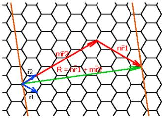
Рис. 1. Для получения нанотрубки  $(n, m)$ , графитовую плоскость надо разрезать по пунктирным линиям и свернуть вдоль направления вектора  $\vec{R} = n\vec{r}_1 + m\vec{r}_2$ . В этом примере  $n = 3$   $m = 5$ .
