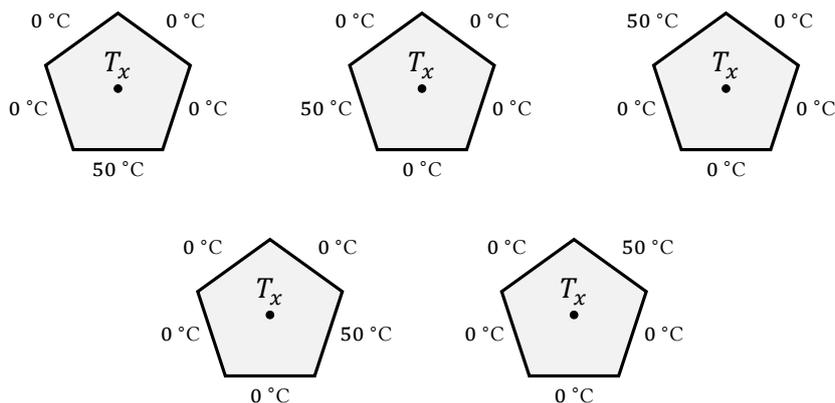
Эти системы симметричны с точностью до поворота, а значит температуры  $T_x$  в центре пластинок одинаковы. Наложим картинки друг на друга. Получится пластина, все стороны которой имеют температуру  $50^\circ\text{C}$ , а значит и во внутренних точках будет температура  $50^\circ\text{C}$ . С другой стороны температура в центре  $5T_x$ , а значит  $T_x = 10^\circ\text{C}$ .
