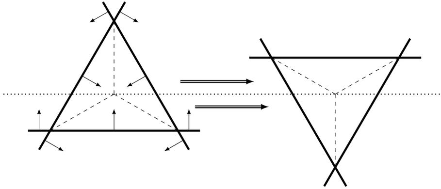
Когда треугольник перевернулся, каждый из стержней прошёл удвоенное расстояние до центра  $r$ . В равностороннем треугольнике расстояние от центра до стороны равно  $r = \frac{\sqrt{3}}{6}a$ , значит треугольник перевернётся через
