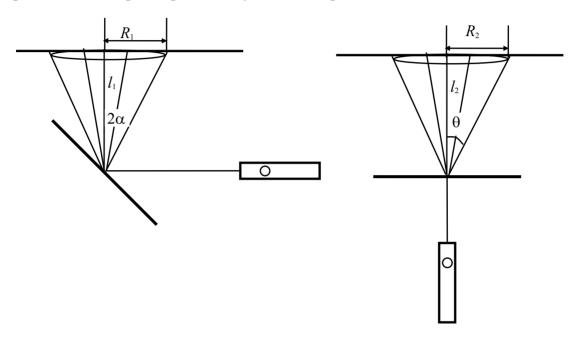
Изменение угла наклона поверхности на величину  $\alpha$  приводит к отклонению отраженного луча на угол  $2\alpha$  .
