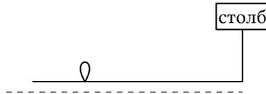
Рис. 6: Сокращение длины веревки при завязывании узелка.
