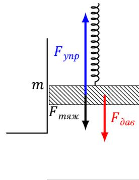
Рис. 8: Нижний поршень
