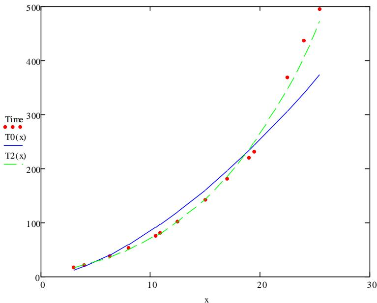
Зависимость быстро возрастающая, нелинейная. Это может быть степенная функция или экспонента. Предположим, что степенная  $t = Ax^b$ . Прологарифмируем ее  $\ln t = b \ln x + \ln A$  и построим зависимость  $\ln t$  от  $\ln x$ :
