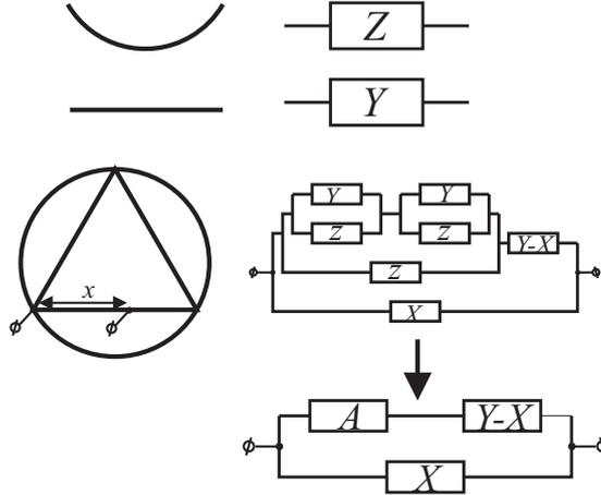
Обозначим сопротивление круга и двух сторон треугольника через  $A$ . Тогда общее сопротивление схемы можно записать следующим образом:
