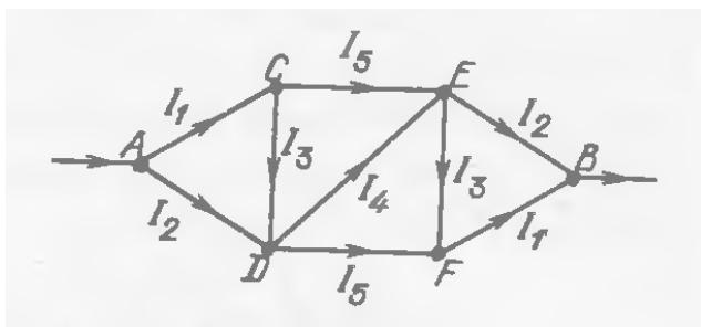
Полученную схему не удается упростить путем разъединения или соединения узлов (или путем удаления каких-нибудь проводников), чтобы упрощенная схема представляла собой лишь параллельные и последовательные соединения проводников. Однако, благодаря симметрии схемы, некоторые токи будут равны, см. рис. 2, таким образом, в схеме 5 неизвестных токов: I<sub>1</sub>, I<sub>2</sub>, I<sub>3</sub>, I<sub>4</sub>, I<sub>5</sub>.
