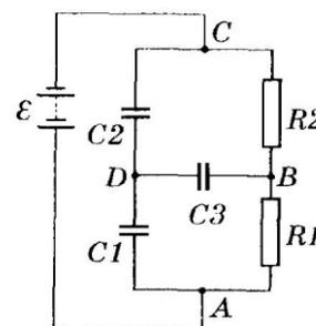
пластинами, конденсаторы  $C_2$  и  $C_3$  – одноименно заряженными.. Так как сумма зарядов в точке D равна нулю, можно записать:  $q_1 - q_2 - q_3 = 0$ . Из схемы видно, что  $E = U_{C1} + U_{C2} = \frac{q_1}{C_1} + \frac{q_2}{C_2}$ .
