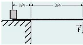
4. На платформе стоит массивный куб. Подсунув под куб плоский лом, выступающий за край платформы на три четверти своей длины, и приложив вертикально вниз к противоположному концу лома силу  $F$ , куб приподнимают. Масса лома  $m$ . Найдите массу лома той же длины, который приподнимал бы куб только за счет собственного веса. Ускорение свободного падения считать данным.
