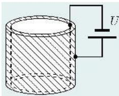
2. Пространство между двумя коаксиальными металлическими цилиндрами заполнено водой, находящейся при температуре  $t_0 = 20$  °С (рис.). Расстояние между цилиндрами равно **1 мм** и значительно меньше их радиусов. Цилиндры подключают к источнику постоянного напряжения  $U =$
