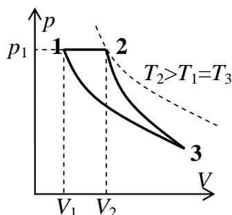
Т.к., при адиабатическом расширении газ охлаждается, то из двух кривых, проведенных из одной точки 3, адиабата круче, чем изотерма (см. рисунок). Поэтому **12 – изобара, 23 – адиабата, 31 – изотерма** ( $T_3 = T_1$ ).
