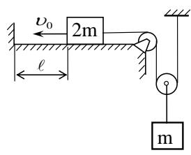
на горизонтальной плоскости. В начальный момент груз  $2m$  находится на расстоянии  $\ell$  от вертикальной стенки и движется к ней со скоростью  $v_0$  и ударяется об неё. Считая удар груза о стенку абсолютно неупругим, определите максимальную высоту  $H$ , на которую поднимется груз  $m$  от начального положения. Нить считать нерастяжимой. Трением и массой нити и блоков пренебречь.
