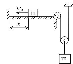
В системе, изображённой на рисунке, груз  $m$  висит на подвижном блоке, а другой груз  $m$  лежит на горизонтальной плоскости. В начальный момент груз  $m$  находится на расстоянии  $\ell$  от вертикальной стенки, движется к ней со скоростью  $v_0$  и ударяется о неё. Считая удар груза о стенку абсолютно неупругим, определите максимальную высоту  $H$ , на которую поднимется груз, подвешенный к блоку, от начального положения. Нить считать нерастяжимой. Трением и массой нити и блоков пренебречь.
