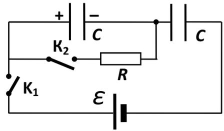
**Ответ на вопрос:** В процессе зарядки напряжение на конденсаторе растет до максимального значения, равного ЭДС источника. Поэтому источник переместит заряд  $q = C\mathcal{E}$ , и совершит работу  $A = q\mathcal{E} = C\mathcal{E}^2$ . Увеличение энергии конденсатора  $\Delta E_C = \frac{C\mathcal{E}^2}{2}$ . Таким образом,  $\frac{\Delta E_C}{A} = 0,5$ , и КПД зарядки изначально не заряженного конденсатора равен 50 %.
