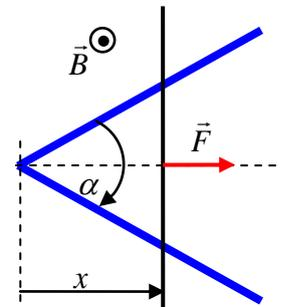
**Ответ на вопрос:** При изменении площади контура в процессе «расправления» магнитный поток через контур будет изменяться, и в контуре возникнет индукционный ток. На этот ток со стороны магнитного поля будет действовать сила Ампера. В соответствии с правилом Ленца, индукционные явления всегда препятствуют причине, вызвавшей их появление. Поэтому силы Ампера обязательно будут направлены внутрь контура, препятствуя увеличению его площади.
