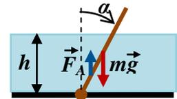
сила реакции шарнира (на рисунке не показана – ее плечо относительно шарнира равно нулю, и в уравнение баланса моментов она не входит). Точка приложения силы тяжести – центр стержня (плечо равно  $\frac{L}{2} \sin(\alpha)$ ), точка приложения силы Архимеда – середина погруженной части стержня (плечо  $\frac{h}{2} \cos(\alpha)$ ). Величина силы Архимеда  $F_A = \rho_0 \frac{h}{\cos(\alpha)} \frac{mg}{\rho SL} = n \frac{h}{L \cos(\alpha)} mg$ .
