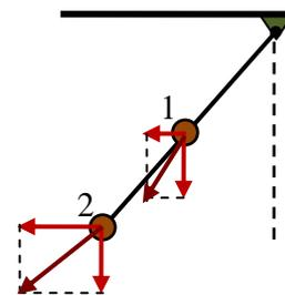
требование:  $mg \frac{L}{2} \sin(\alpha) + mgL \sin(\alpha) - m\omega^2 \frac{L}{2} \sin(\alpha) \frac{L}{2} \cos(\alpha) - m\omega^2 L \sin(\alpha) L \cos(\alpha) = 0$ .
