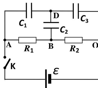
Ток, текущий по замкнутому контуру,  $I = \frac{\mathcal{E}}{R_1 + R_2 + r}$ . С учетом полярности записи
