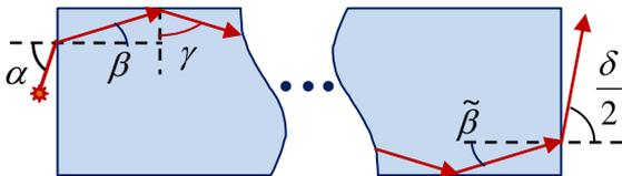
распространяется, оставаясь симметричным относительно оси, и поэтому максимальный угол преломления при выходе из «дальнего» торца равен  $\delta/2$ . Согласно закону преломления, максимальный угол преломления на «ближнем» торце световода равен
