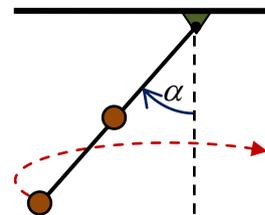
**Ответ на вопрос:** При вращении груза в горизонтальной плоскости вертикальная составляющая силы натяжения нити должна уравновешивать вес груза ( $F \cos(\alpha) = mg$ ), а «радиальная» – создавать центростремительное ускорение груза при вращении ( $F \sin(\alpha) = m\omega^2 L \sin(\alpha)$ ). Разделив эти соотношения друг на друга, вычисляем угловую скорость вращения  $\omega = \sqrt{\frac{g}{L \cos(\alpha)}}$ . Период вращения конического маятника
