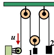
**Ответ на вопрос:** Каждый подвижный блок дает выигрыш в силе в два раза. Поэтому для получения выигрыша в силе в 8 раз необходимо минимум 3 подвижных блока, соединенных последовательно ( $2^3=8$ ).
