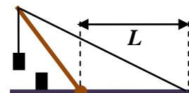
нерастяжимого троса прикреплен к поверхности в точке, которая удалена от шарнира на расстояние, равное длине стержня (см. рисунок). Длина троса в  $\sqrt{3}$  раз больше длины стержня. Когда к концу стержня подвесили небольшой груз, то сила натяжения нити оказалась равна 21 Н. После подвешивания к первому грузу второго (точно такого же) эта сила возросла до 26 Н. Найдите массу стержня и каждого из грузов. Ускорение свободного падения  $g \approx 10 \text{ м/с}^2$ .
