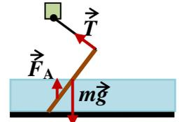
Запишем правило рычага:  $T_0 L - mgl = 0 \Rightarrow T_0 = \frac{l}{L} mg$ . После появления
