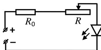
**Ответ на вопрос:** Мощность, потребляемая элементом цепи постоянного тока,  $P = U \cdot I$ . Если напряжение практически постоянно, то эта мощность изменяется пропорционально силе тока. Поэтому при увеличении протекающего через светодиод тока в два раза его мощность потребления возрастает тоже в 2 раза.
