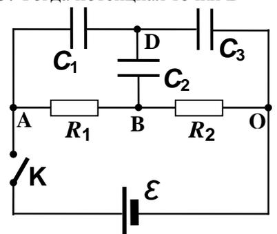
Ток, текущий по замкнутому контуру,  $I = \frac{\mathcal{E}}{R_1 + R_2 + r}$ . С учетом полярности записи
