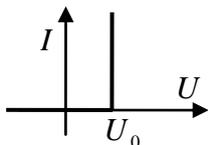
которых показана на рисунке ( $U_0 = 1\text{В}$ ). Если включить в гирлянду  $n_1 = 10$  светодиодов, то полная потребляемая ими мощность составит  $P_1 = 175\text{Вт}$ , если включить  $n_2 = 28$  светодиодов, то  $P_2 = 238\text{Вт}$ . Определите «оптимальное» число светодиодов, при котором потребляемая мощность
