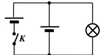
потребляет мощность  $P_1 = 6 \text{ Вт}$ . Какой станет потребляемая лампой мощность после замыкания ключа?
