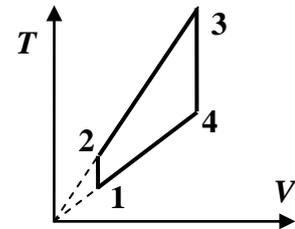
**Решение:** Нетрудно заметить, что процессы 1-2 и 3-4 – изохорные, а процессы 2-3 и 4-1 – изобарные (температура растет пропорционально объему). Таким образом, в координатах давление-объем диаграмма этого цикла имеет вид прямоугольника. Пусть  $T_2 = xT_1$ . Тогда,
