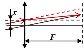
показанным на рисунках справа и слева. Как видно из построения, если падающий луч идет под углом  $\alpha$  к оси, то преломленный луч идет к оси под углом  $\beta$ , для которого
