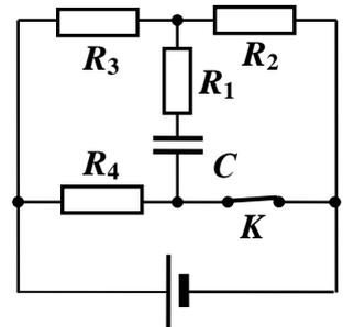
$R_2$  и  $R_3$  соединены между собой последовательно и оба они параллельны  $R_4$ , то ток в ветви
