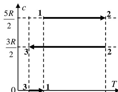
**Решение:** Как видно по значениям теплоемкости, цикл состоит из изобары (1-2), изохоры (2-3) и адиабаты (3-1). Теплота нагревателя  $Q_H = Q_{12} = \frac{5}{2} R(T_2 - T_1)$ , а теплота холодильника
