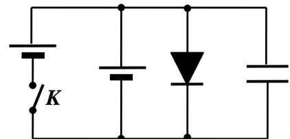
Пока ключ  $K$  разомкнут, конденсатор заряжен до заряда  $q_1$ . Какой заряд будет на конденсаторе в установившемся режиме после замыкания ключа?
