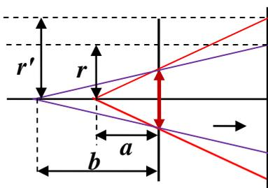
изображение источника мнимое (см. рис.) Пусть  $a$  - расстояние от источника до линзы,  $b$  - расстояние от мнимого изображения до линзы (по модулю). Из подобных треугольников имеем:
