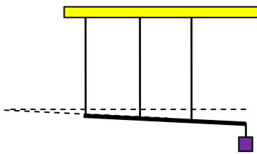
ее деформация есть точно полусумма деформаций этих нитей, или  $2x_2 = x_1 + x_3$  (см. рисунок, на котором для наглядности деформации показаны увеличенными). Нити по условию одинаковы, поэтому коэффициенты жесткости у них также одинаковы, и поэтому  $2T_2 = T_1 + T_3$ . Из этого
