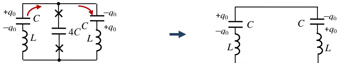
ток всегда равен нулю, и его можно убрать из схемы. Последовательно соединенные конденсаторы  $C$  оказываются в данном контуре эквивалентны одному конденсатору емкостью  $\frac{C}{2}$ , а две последовательно соединенные катушки  $L$  – одной с индуктивностью  $2L$ .
