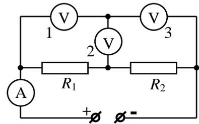
**Ответ на вопрос:** это связано с тем, что вольтметр неидеален, то есть имеет конечное внутреннее сопротивление  $R$ , и батарейка имеет ненулевое внутреннее сопротивление  $r$ . Если разность потенциалов, создаваемая на полюсах ненагруженной батарейки, равна  $U_0$ , то ток через вольтметр и батарейку будет равен  $I = \frac{U_0}{R+r}$ , и напряжение на вольтметре
