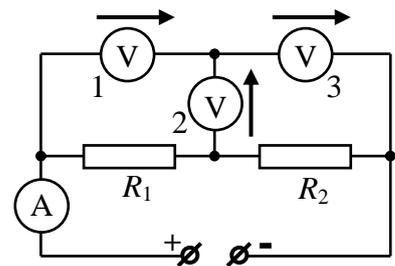
вольтметр 3 равен сумме токов через вольтметры 1 и 2, а их сопротивления одинаковы, то
