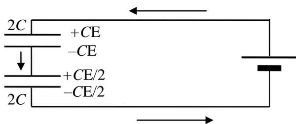
На рисунке показаны начальные заряды конденсаторов и направление движения зарядов. Заряды перемещаются до того момента, когда сумма напряжений на конденсаторах станет равна ЭДС:
