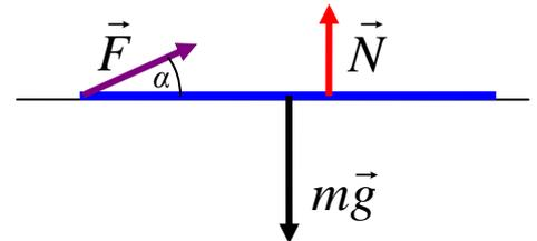
Для определения минимального значения силы определим угол  $\alpha_0$ , для которого  $\sin(\alpha_0) = \frac{\mu}{\sqrt{1+\mu^2}}$ ,  $\cos(\alpha_0) = \frac{1}{\sqrt{1+\mu^2}}$
