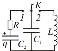
Ключ  $K$  на длительное время переводят в положение 1, а затем в положение 2. Зная сопротивление резистора  $R$ , емкости конденсаторов  $C_1$  и  $C_2$  и амплитуду  $I_0$  тока в контуре  $LC_1$ , определите индуктивность  $L$  катушки.
